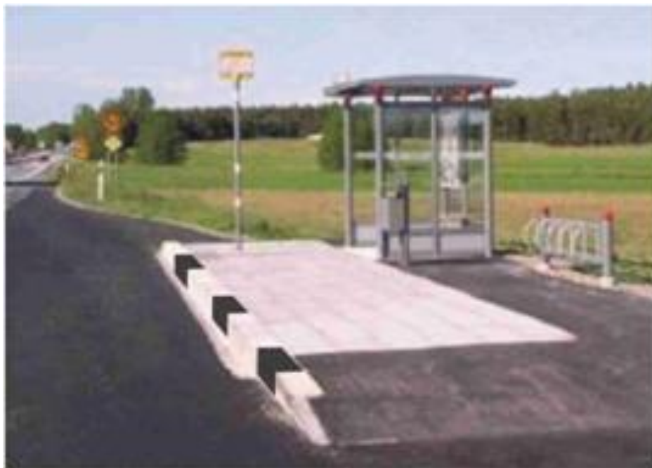
Рисунок 41 Пример организации пандуса на остановочном пункте
