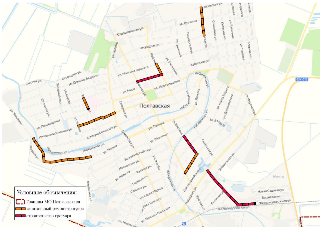
Рисунок 23 Расположение тротуарных объектов, планируемых к строительству
