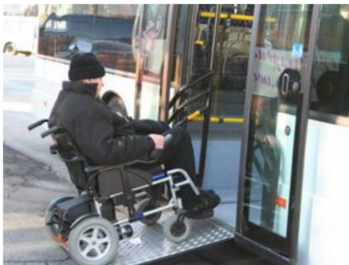
Рисунок 32 Организация посадки в низкопольный автобус инвалида- колясочника
