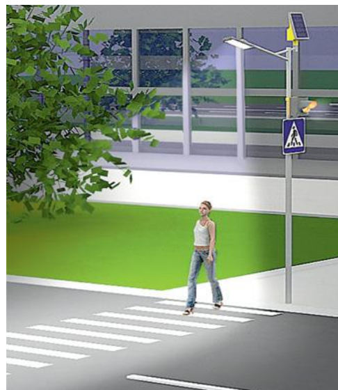
Рисунок 43 Комплект освещения пешеходного перехода на солнечных электростанциях
