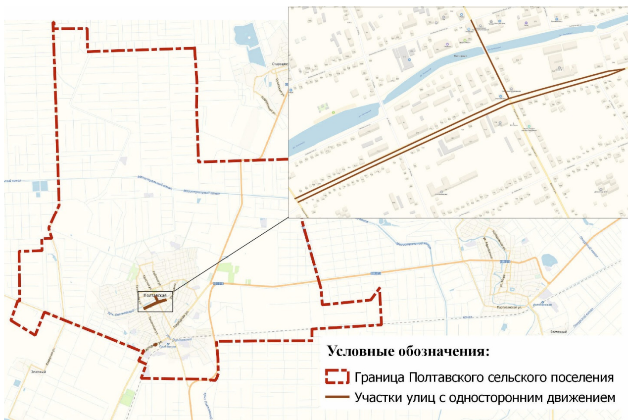
Рисунок 10. Схема размещения улиц с односторонним движением
